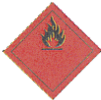
materie liquide infiammabili
